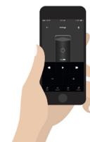
Mode 'Twin' pour jumeler 2 ESCAPE P6BT dans une configuration stéréo via Bluetooth®. La distance entre deux P6BT et la source audio ne peut pas dépasser 4m.
