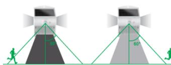
Mode A : S'allume automatiquement en pleine lumière (220lm) lorsqu'un mouvement est détecté dans un rayon ≤ 6m et reste ensuite allumé à faible luminosité après 10 secondes (lumière frontale et arrière) si aucun mouvement n'est à nouveau détecté.
