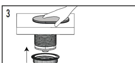
Insérez le câble d'alimentation et le corps de la prise dans le trou du plan de travail.
