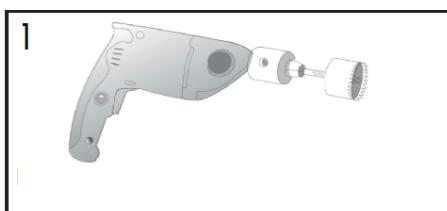
Avant l'installation, percez un trou dans le plan de travail à l'aide de la scie cloche (1) pour y placer la douille. Le diamètre du trou doit être de 60 mm (2).
