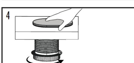
Passez l'anneau de montage à travers le câble d'alimentation, vissez-le dans le corps puis sous le plan de travail.
