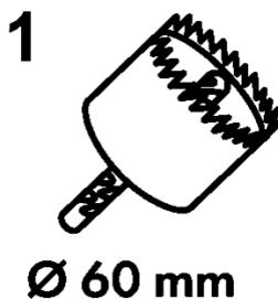
Avant l'installation, percez un trou dans le plan de travail à l'aide de la scie cloche (1) pour y placer la douille. Le diamètre du trou doit être de 60 mm (2).
