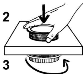
Une fois le trou réalisé, retirez la bague de montage du corps et insérez le câble d'alimentation et le corps de la prise dans le trou du plan de travail.
