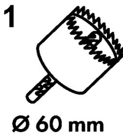
Avant l'installation, percez un trou dans le plan de travail à l'aide de la scie cloche (1) pour y placer la douille. Le diamètre du trou doit être de 60 mm (2).
