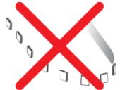
Ne pas plier le bandeau LED à un diamètre inférieur à 25 mm
