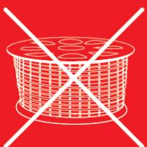
Ne pas utiliser le bandeau LED lorsqu'il est enroulé
