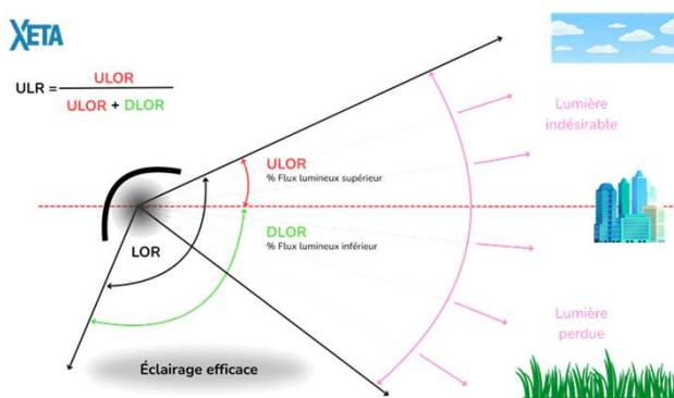
ULR (Upward Light Ratio) correspond au rapport du flux sortant
